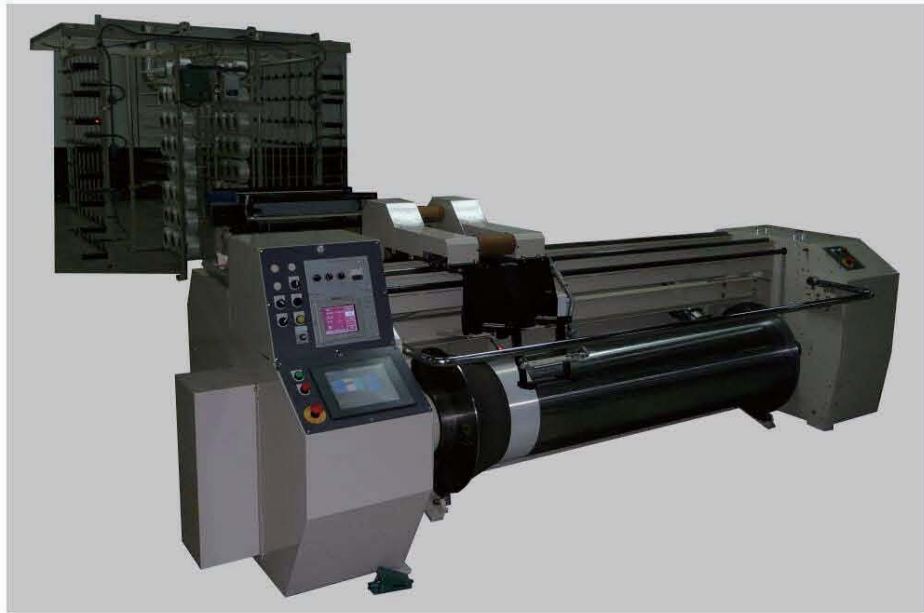
▲筒子架和分条整经机 Creel & Sectional Warper
